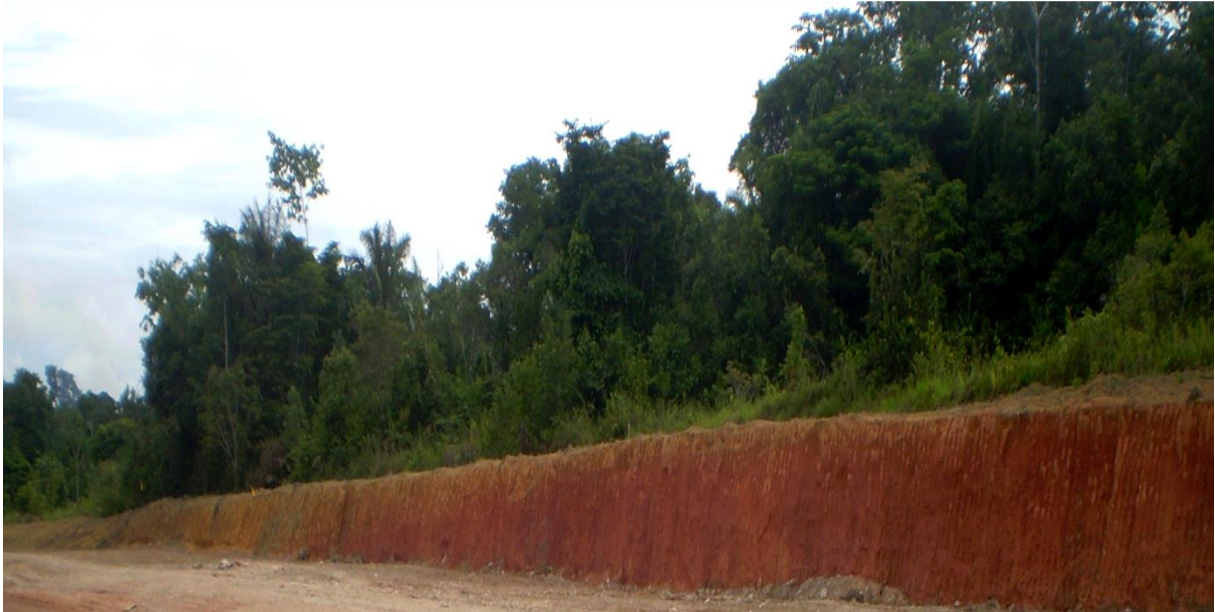
Figura 9 - Paisagens de um corte de estrada no sul do estado (município de Rorainópolis), expondo perfil de PLINTOSSOLO PÉTRICO Concrecionário associado a Latossolo Vermelho-Amarelo.
